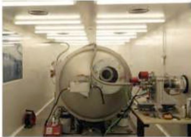
El instrumento CARMENES para la búsqueda de planetas de tipo terrestre desde el Observatorio de Calar Alto.
