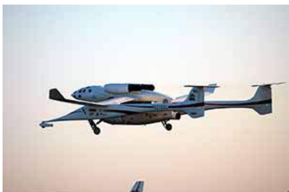
La SpaceShipOne adosada al avión White knight, diseñado específicamente para hacer despegar a la nave suborbital. Imágenes de Wikipedia
