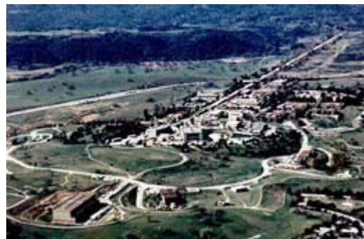
Figura 1.10: El SLAC, ubicado al sur de San Francisco, acelera electrones y positrones a lo largo de algo más de tres kilómetros hacia varios blancos, anillos y detectores ubicados en su finalización. Este acelerador hace colisionar electrones y positrones, estudiando las partículas resultantes de estas colisiones.
