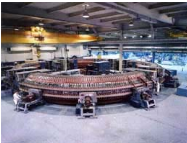
Figura 1.3: El primer acelerador de partículas de la historia, el Cosmotrón de Brookhaven, capaz de acelerar protones hasta energías de unos pocos GeV (Para el LHC hablamos de unos pocos TeV).
