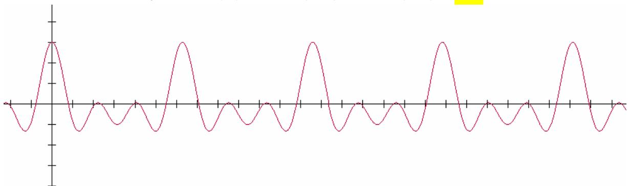
Vemos fácilmente que esto es una función periódica, en la medida que se agregan frecuencias (múltiplos de una fundamental) se puede ir aproximando a cualquier '*forma*', una onda cuadrada, triangular, etc...
